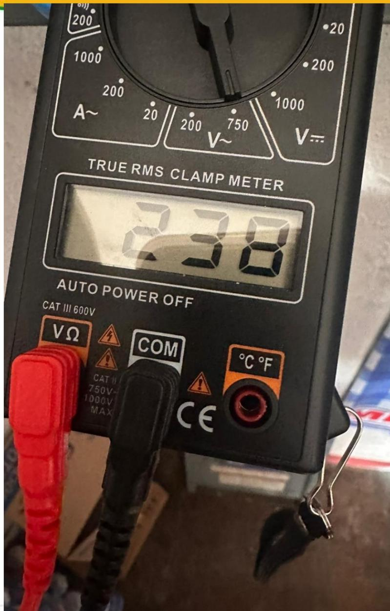
Medición de voltaje entre fase 1 y neutro, fase 2 y neutro.
