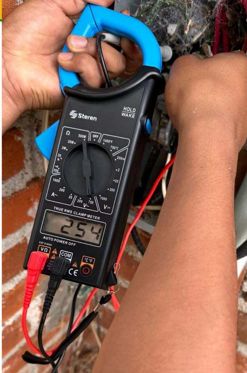
Medición de voltaje entre fase 1 y neutro, fase 2 y neutro.
